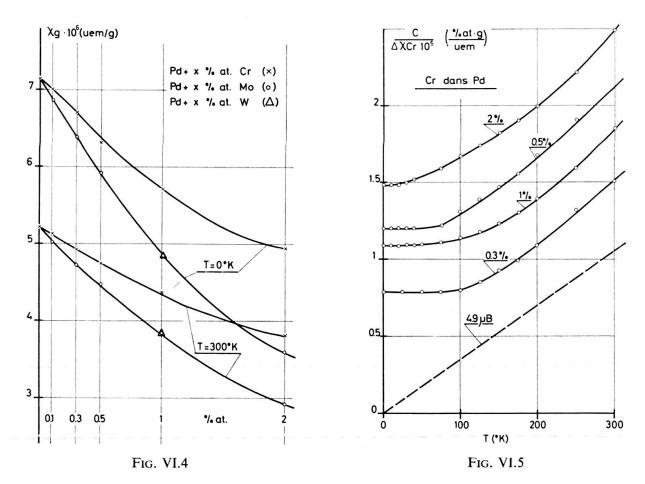
part l'interversion des courbes pour 0,5 et 1 % Cr, on peut noter une température de Curie-Weiss négative augmentant avec la concentration en Cr, et indiquant de fortes interactions antiferromagnétiques Cr-Cr.
