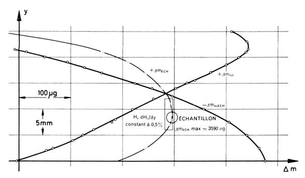
Fig. II.4 —  $\Delta m$  (y) pour une sphère de Nb ( $\varnothing$  2 mm) — Position Hélipot: 500 (\*) L'origine de y est arbitraire: on peut néanmoins estimer la position idéale  $y(\Delta m_{ECH} max)$  à (51 ± 1) mm du point d'étranglement des pièces polaires, où l'entrefer est minimum.
