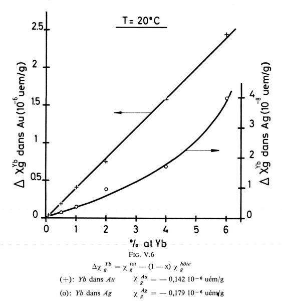
Au + 0,1 % Yb et Au + 0,5 % Yb en même temps que les mesures de (V.6) sur un spécimen Au + 0,9 % Yb (toutes les mesures sont normalisées pour une concentration de 1 % Yb). On remarque que le comportement anormal à basse température se retrouve d'une manière semblable pour les trois concentrations. Le point d'inflexion à environ 30° K dans l'allure de  $c/\chi_q - \chi_{Au}$  est certainement dû à des effets du champ
