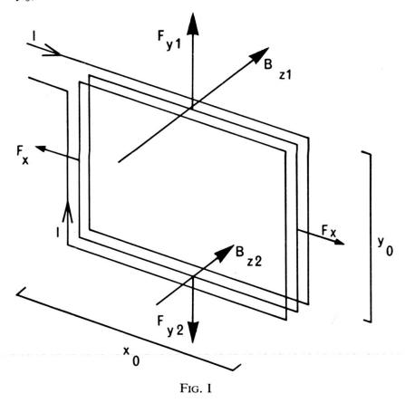
La quantité  $p = NIx_0y_0/c$  est qualifiée de « moment magnétique de la bobine ». Si les boucles de courant sont remplacées par un échantillon de substance de moment magnétique p, l'équation  $F_v = pdB_z/dy$  est toujours valable.
