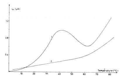
Fig. 17. — Influence de la température sur le courant de dissolution  $i_m$  du Fe<sup>o</sup> (1) et du Zn<sup>o</sup> (2).
