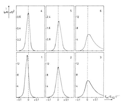
Fig. 2. — Influence de la vitesse de balayage v et de l'épaisseur l du film de mercure sur l'allure des courbes de dissolution d'un métal Me selon la réaction:
