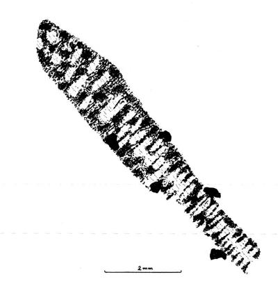
Fig. 57 (pl. m. 78 V). — Section allongée de pyroxène altéré; le pyroxène est résorbé en granules verts très ténus, et envahi de quartz assez limpide. Grains semi-opaques de nature titanifère. Le tout dans un fond albito-chloritique, très chargé de grains d'épidote et de fibres amphiboliques.
