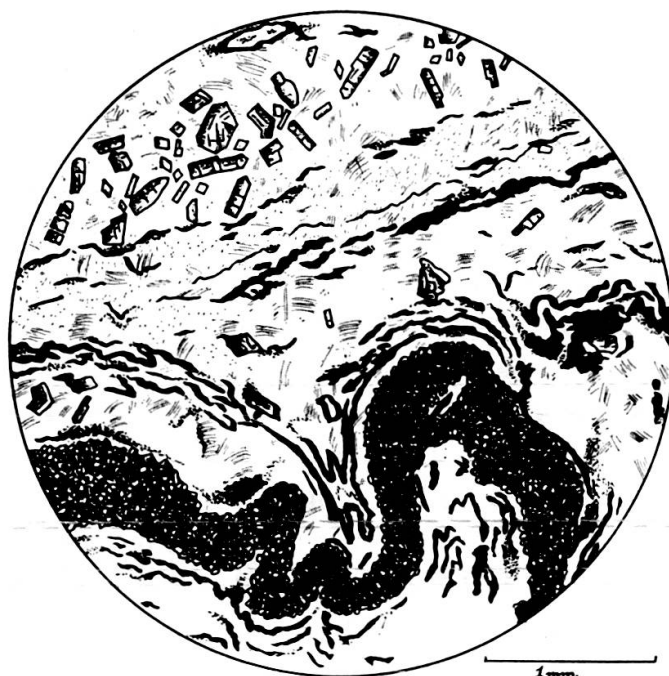
FIG. 5 (pl. m. 3 V). Lum. nat. — Dans un « fond » phylliteux, garni de quelques petits phénoblastes d'albite, les cristaux épidotiques sont soit dispersés, soit groupés en lits assez épais, replissés; lits interrompus, beaucoup plus minces, plissés, de grains semi-opaques (leucoxène).
