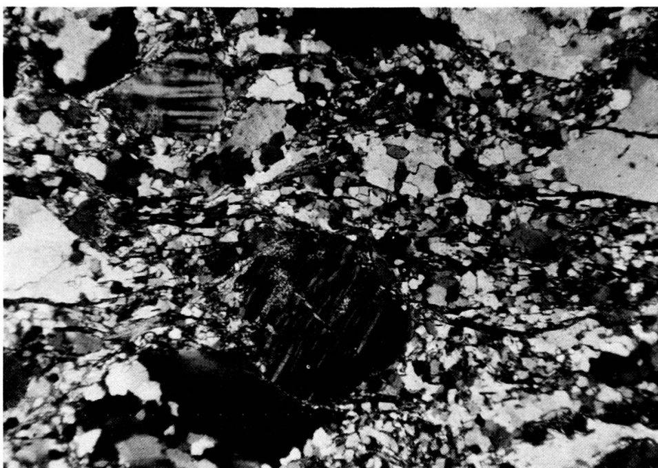
FIG. 6. — Arkose quartzito-séricitique à microcline n° 5 M. Lumière polarisée. G = 20\times .
