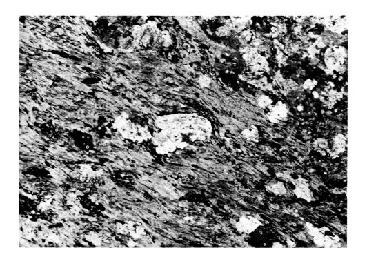
Fig. 2. — Ovardite chlorito-séricitique  $n^o$  49 M. Lumière polarisée.  $G = 9 \times$ .
