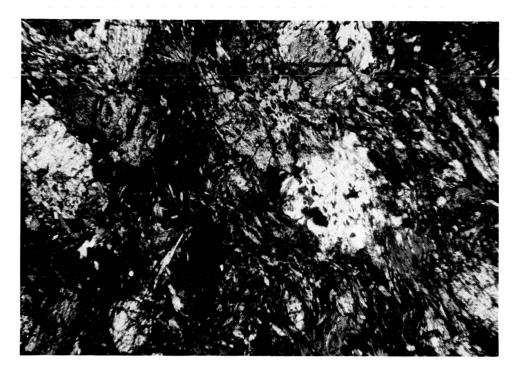
Fig. 4. — Prasinite à glaucophane  $n^o$  76 M. Lumière polarisée.  $G=20\times$ .
