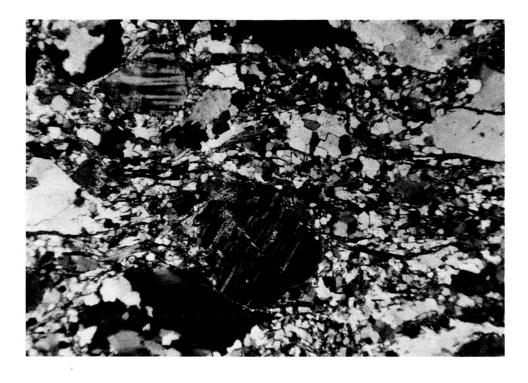
Fig. 6. — Arkose quartzito-séricitique à microcline  $n^o$  5 M. Lumière polarisée.  $G=20\times$ .
