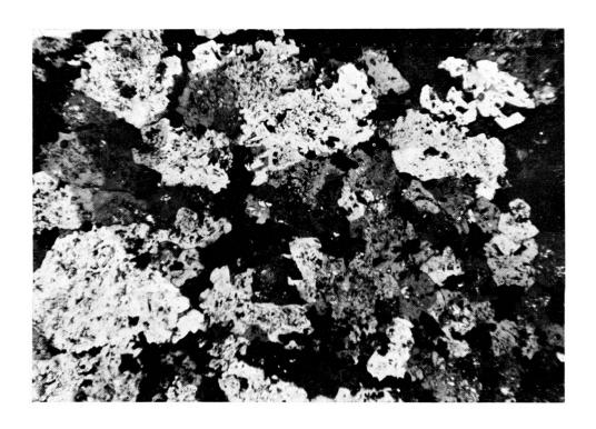
Fig. 3. — Albitite quartzifère nº 55 M. Lumière polarisée.  $G = 20 \times$ .
