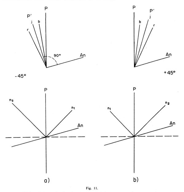
Schéma de la production de teintes asymétriques avec analyseur décroisé.
