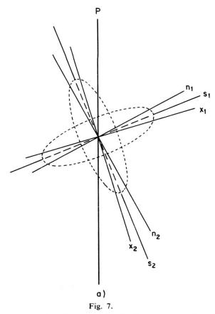
Schéma de l'ellipticité des rayons réfléchis, selon les indices n et  $\kappa$ , dans les sections de cristaux biaxes, non perpendiculaires à un plan de symétrie (ellipticité très exagérée).
