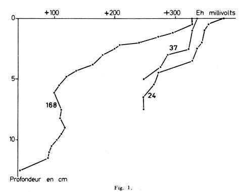
Le potentiel d'oxydo-réduction dans les carottes Mortimer.
