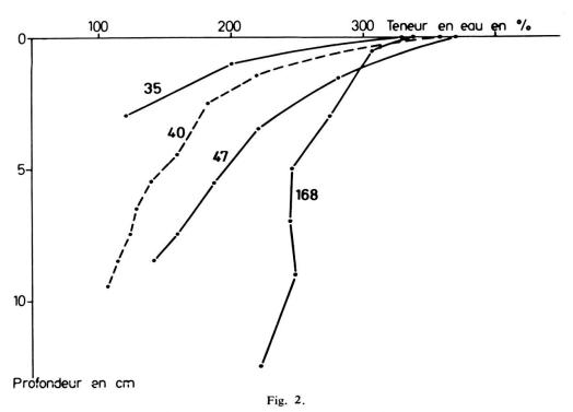
Teneur en eau des vases en fonction de la profondeur de prélèvement. Les nombres accompagnant chaque courbe indiquent, en mètres, la profondeur du prélèvement.
