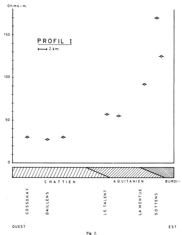
Résistivités des molasses mesurées sur des affleurements avec AB = 40 mètres.
