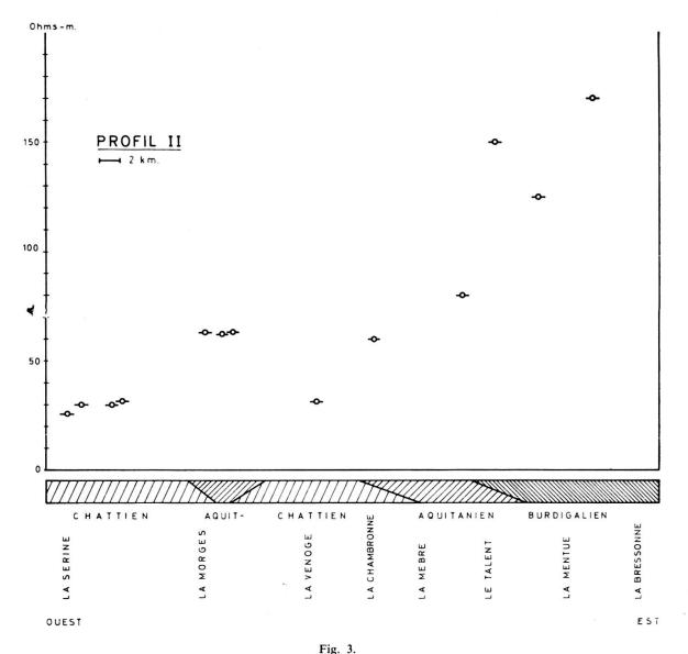
Résistivités des molasses mesurées sur des affleurements avec AB = 40 mètres.
