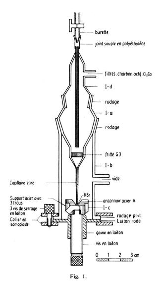
Dispositif pour la micro-extraction de produits des supports de chromatographie en couche mince. L'entonnoir en acier A est remplacé par une micro-cuvette en verre.
