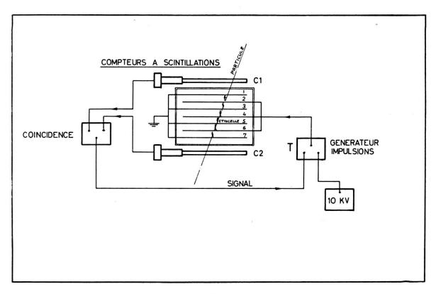
Fig. 1. Schéma de principe des chambres à étincelles.
