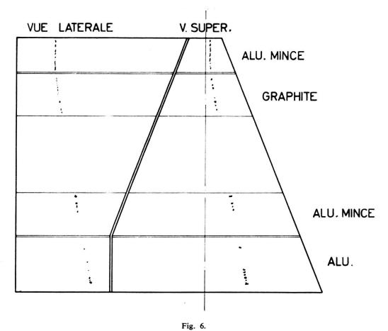
Diffusion d'un proton de 600 MeV dans les chambres « graphite » du polarimètre.
