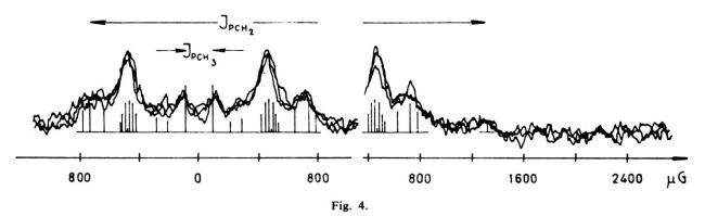
Résonance protonique du triéthylphosphate dans le champ magnétique terrestre.
