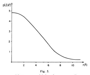
Distribution du moment magnétique p par unité de volume autour d'un noyau de Fe dissous dans le Pd: mesures de Low par diffraction aux neutrons  $^{13}$ ).
