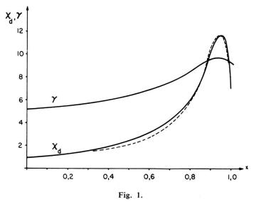
Susceptibilité  $\chi_d \cdot 10^6$  (U.E.M. Mole<sup>-1</sup>) et chaleur spécifique électronique  $\gamma$  (mJ deg<sup>-2</sup> mole<sup>-1</sup>) dans l'alliage Rh<sub>(1-x)</sub> Pd<sub>x</sub>: valeurs expérimentales de Budworth et al. <sup>1</sup>) et calculées à partir de la formule (3) (en pointillé).
