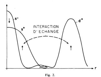
Représentation du mécanisme de polarisation nucléaire due aux électrons d:  $d^+$  est la densité des électrons d de polarisation positive,  $s^{\pm}$  celle des électrons s des différentes polarisations.
