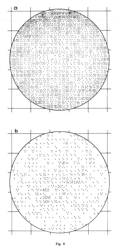
Répartition des *Synedra ulna* dans le sédiment de la chambre à plaques, 8a: préparée sous forme de chambre combinée. Densité plus élevée à la périphérie. 8b: remplie à la pipette. Densité plus élevée au centre.
