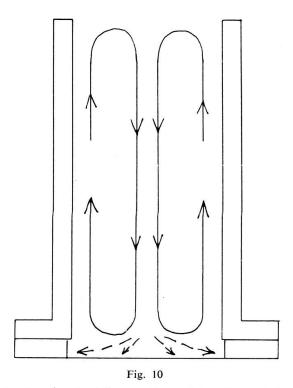
Courants thermiques dans la chambre à sédimentation: réchauffement du liquide le long des parois, et déplacement du sédiment vers la périphérie.
