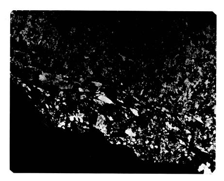
Fig. 2 Nodule feldspathique dans un gneiss. Echantillon no 36. Lumière polarisée. G=7~X.
