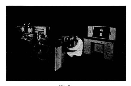
Fig. 3. Comparateur longitudinal photo-électrique
