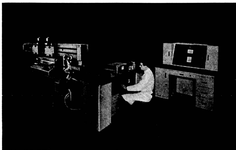
Fig. 3. Comparateur longitudinal photo-électrique pour la comparaison de règles jusqu'à 1 mètre avec les interférences.
