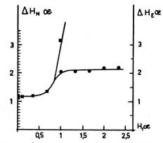
⊗ largeur ∆H<sub>N</sub> entre points d'inflexion de la courbe d'absorption nucleaire à 82 KHZ
