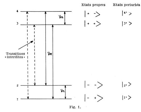
Dans ces conditions les niveaux énergétiques et les états propres sont montrés sur la figure 1. L'état |+-> par exemple représente l'état caractérisé par  $S_z=+\frac{1}{2}$  et  $I_z=-\frac{1}{2}$  (le premier signe concerne le spin électronique, le deuxième le spin nucléaire);  $S_z$  et  $I_z$  sont les composants
