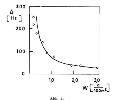
Protonenresonanzverschiebung  $\Delta$  von n-Heptan, das an Kohle (Shawinigan Acetylene Black) sorbiert ist, als Funktion des n-Heptan-Gehalts W (in g n-Heptan pro 100 m² Adsorbensoberfläche), nach [39].
