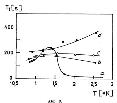
Spin-Gitter-Relaxationszeit  $T_1$  von flüssigem  $He^3$  als Funktion der Temperatur und des Gefässes (Pyrexglasgefäss mit Innendurchmesser a) d = 3 mm, b) d =6 mm, c) d = 10 mm; d) wie c), aber Reinigung des Probengefässes mit Wasserstoffgas bei 150° C zur Entfernung der an der Gefässwand adsorbierten Gase, die durch  $H_2$  ersetzt werden); nach Careri und Mitarbeitern [32].
