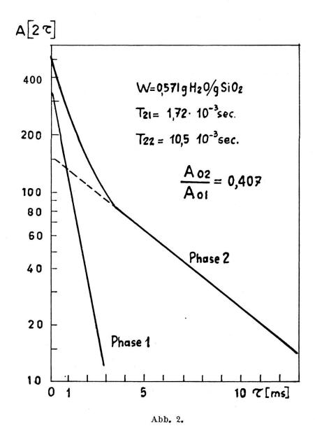
Amplitude A ( $2\tau$ ) einer Hahnschen Echoserie (in logarithmischer Darstellung) von Wasser, das an Silicagel adsorbiert ist (nach Zimmerman und Mitarbeitern [11]).  $\tau$  ist der zeitliche Abstand der beiden Impulse.
