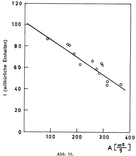
Intensität I der  $Al^{27}$ -Kernresonanz (Übergang  $+\frac{1}{2} \rightarrow -\frac{1}{2}$ ) als Funktion der spezifischen Oberfläche A des verwendeten  $\gamma$ - $Al_2O_3$  (nach O'Reilly [42]).
