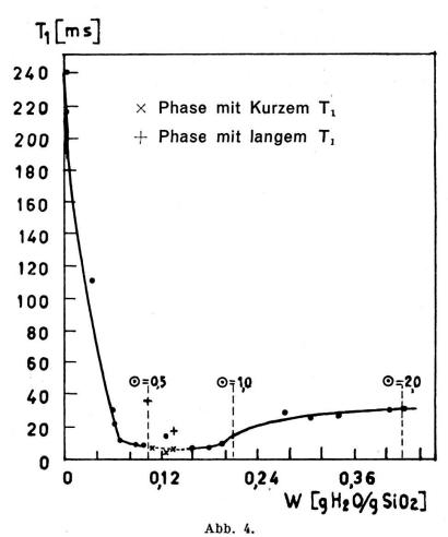
Longitudinale Relaxationszeit  $T_1$  für Protonen des Wassers, das an Silicagel adsorbiert ist, als Funktion des Wassergehalts W (nach Zimmerman und Lasater [12]).
