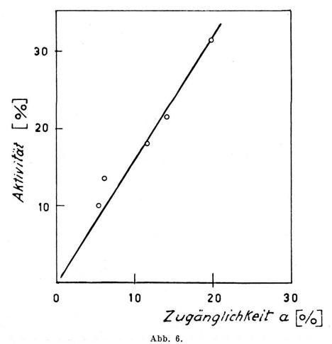
Aktivität eines  $Cr_2O_3 - Al_2O_3$  - Katalysators für die Dehydrozyklisierung von n-Heptan, gemessen in Gewichtsprozent des entstehenden Toluols in der Flüssigkeit, als Funktion der Zugänglichkeit a (nach Selwood und Schroyer [18]).
