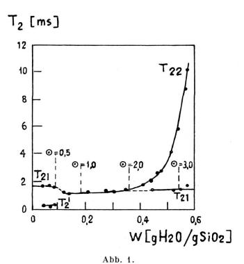
Transversale Relaxationszeit  $T_2$  für Protonen des Wassers, das an Silicagel adsorbiert ist, als Funktion des Wassergehalts W (nach Zimmerman und Mitarbeitern [11]).  $\theta$  ist die Anzahl der monomolekularen Schichten.
