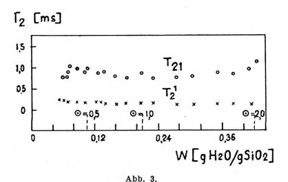
Transversale Relaxationszeit  $T_2$  für Protonen des Wassers, das an Silicagel adsorbiert ist, als Funktion des Wassergehalts W (nach Zimmerman und Lasater [12]).
