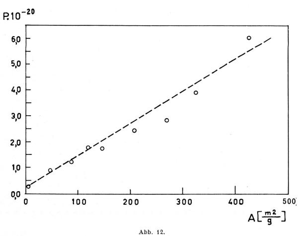
Anzahl P der Protonen in einem Siliziumdioxyd-Tonerde-Katalysator (pro Gramm Katalysator) als Funktion der spezifischen Oberfläche A (nach O'Reilly [42]).
