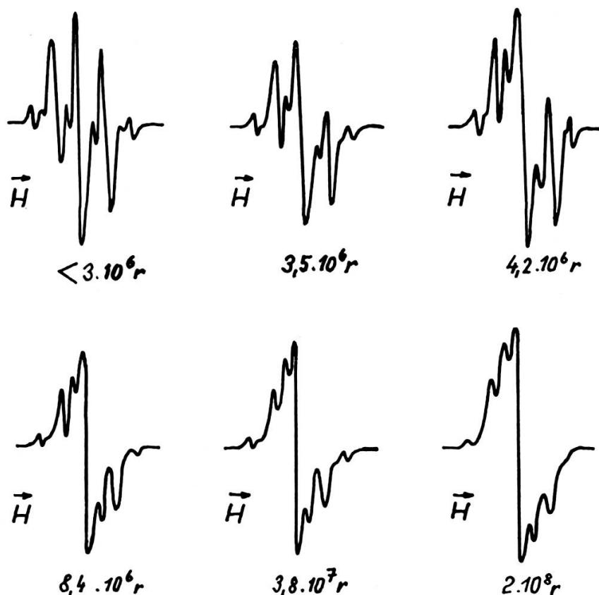
Die Verminderung der Seitenlinien der Hyperfeinstruktur wurde an den Proben beobachtet, die entweder auf der Luft oder im Vakuum bestrahlt worden waren. Die Bestrahlung und das Messen der Spektren wurde bei Zimmertemperatur durchgeführt.
