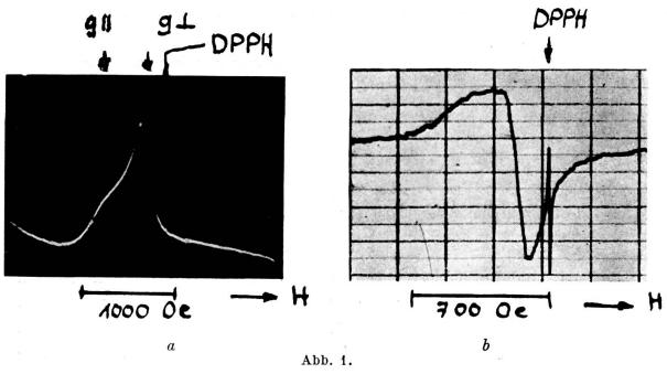
EPR-Spektrum von polykristallinem Cu-Phthalocyanin a) bei 8 mm; b) bei 3,2 cm — 1. Ableitung.
