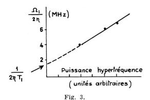
Résultats expérimentaux et détermination du  $T_1$  (DPPH).
