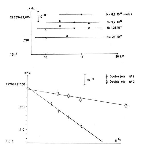
tensions des sélecteurs d'états et le nombre de molécules dans l'autre jet étant maintenus constants (fig. 1). La fréquence passe par un minimum lorsque les deux jets sont équilibrés. Pour un nombre nul de molécules dans l'un des deux jets, l'on obtient la fréquence du maser à simple jet  $(22\ 789\ 421\ 731\ \pm 1\ Hz$  en  $TA_1$ ).
