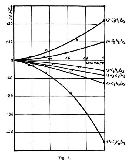
Variation de la constante diélectrique, dans le champ d'intensité  $E = 5 \frac{kV}{\text{cm}}$ , en fonction de la concentration molaire pour les 1,n-dibromoparafines.
