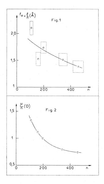
Nous avons réalisé cette expérience par absorption diélectrique sur cinq échantillons de poly-L-γ-glutamate de benzyle de masse moléculaire moyenne en poids comprise entre 24.000 et 100.000 en solution dans le chloroforme contenant 0,5% de formamide pour détruire d'éventuels agrégats. Les concentrations en poids comprises entre 3.10<sup>-4</sup> et 12.10<sup>-4</sup> étaient suffisamment faibles pour que les interactions macromoléculaires
