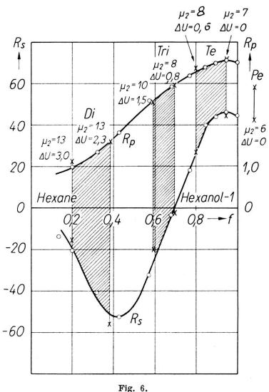
Les facteurs  $R_p$  et  $R_s$  d'après les mesures de J. Malecki [12] pour l'hexanol - 1 dans l'hexane (la plus faible interaction avec le solvant). Les petites croix indiquent les valeurs de  $R_p$  et  $R_s$  calculées d'après les formules (27) et (28) pour un système de dimères (Di), trimères (Tri), tétramères (Té) et pentamères (Pe); c. [18].
