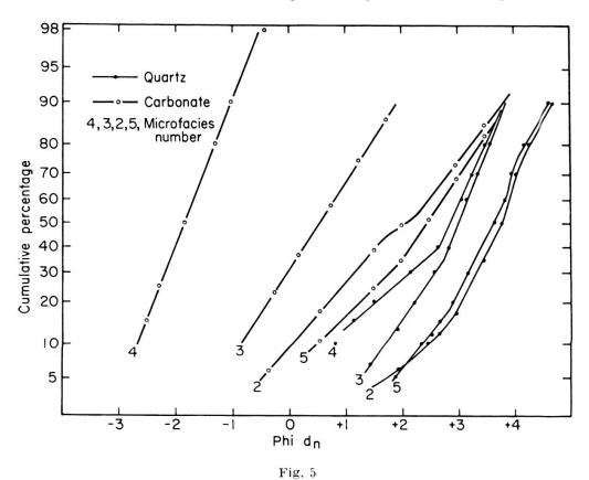
Courbes cumulatives des grains de quartz et des grains carbonatés lithiques par microfaciès en Phi diamètre nominal.
