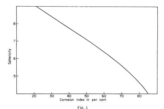
Relation entre l'indice de corrosion en % et la sphéricité.
