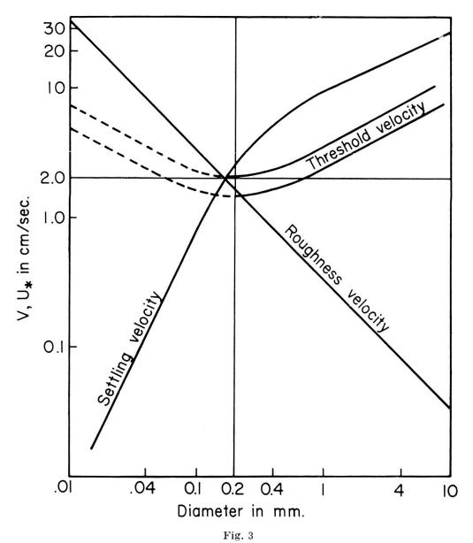
Relation entre le diamètre des grains, la vitesse de chute (settling velocity), la vitesse de seuil (threshold velocity) et la vitesse de rugosité (roughness velocity). (Modifié d'après Inman, 1949, planche 2, p. 56.)
