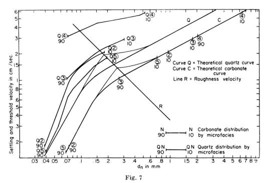
Relation entre la distribution des grains de quartz et des grains carbonatés lithiques en diamètre nominal et les vitesses théoriques de chute et de seuil.
