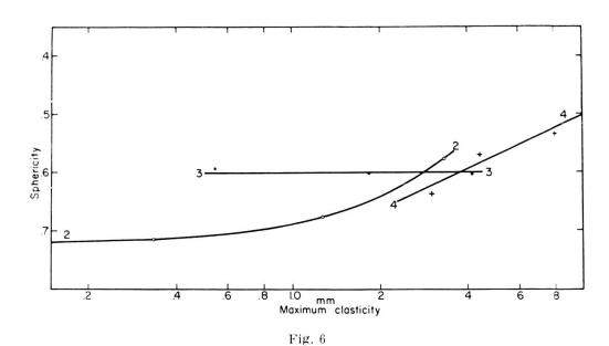
Relation entre la sphéricité et la clasticité maximale des grains carbonatés lithiques par microfaciès.
