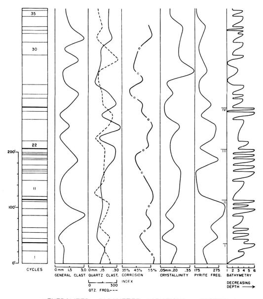
GENERALIZED PARAMETER VARIATIONS — SECTION I Fig. 15 Variation généralisée des paramètres dans la coupe 1.
