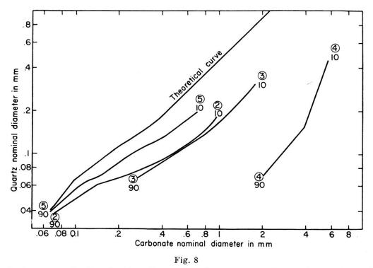
Relation entre la distribution des grains de quartz et des grains carbonatés lithiques en diamètre nominal par microfaciès.
