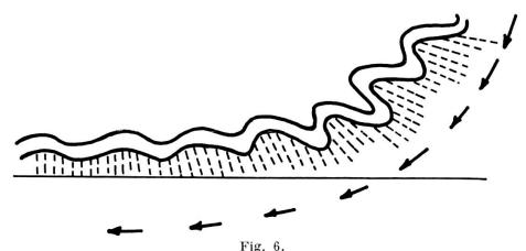
Schéma montrant les variations dans l'allure des plis et dans la disposition du clivage schisteux.
