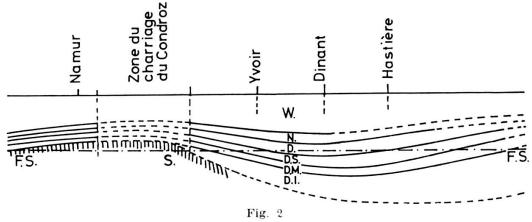
Schéma montrant l'épaisseur relative probable des terrains paléozoïques (Dévono-Carbonifère) dans une coupe subméridienne passant par Namur.  $W = \text{Westphalien}; \ N = \text{Namurien}; \ D = \text{Dinantien};$   $\text{Ds-m} = \text{Dévonien supérieur et moyen}; \ Di = \text{Dévonien inférieur};$   $S = \text{Silurien}; \ F S = \text{front supérieur de schistosité}.$
