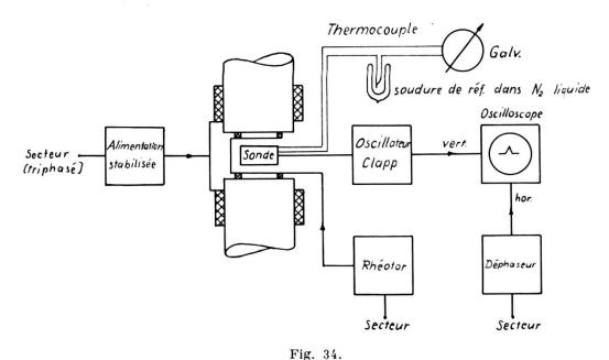
Schéma de principe du spectromètre.
