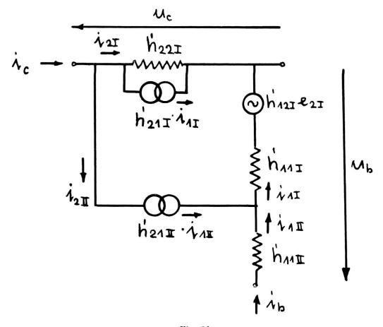
Fig. 30. Schéma équivalent pour T<sub>1</sub> et T<sub>2</sub>.
