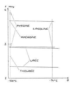
Fréquences des résonances quadripolaires observées et coefficients de couplage et d'asymétrie
