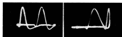
Au moment du passage par la fréquence de résonance de l'échantillon, l'absorption de l'énergie par celui-ci peut être représenté par une conductance équivalente, qui s'ajoute au  $G_i$ . La conductance négative  $G$  (formule 3) diminue et le gain de l'amplificateur aussi. La raie d'absorption se traduit ainsi par une diminution de la tension de sortie de l'amplificateur.
