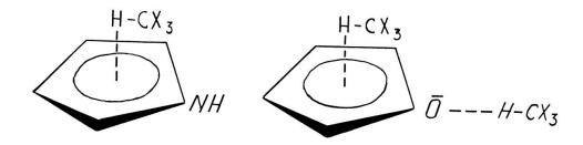
Fig. 3. Complexation des N- et O-hétérocycles avec les accepteurs  ${\rm CHX_3}$ .
