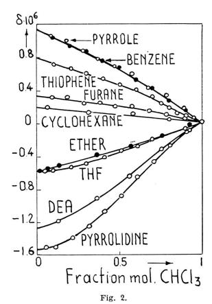
Déplacement chimique de la raie du chloroforme dans divers solvants.
