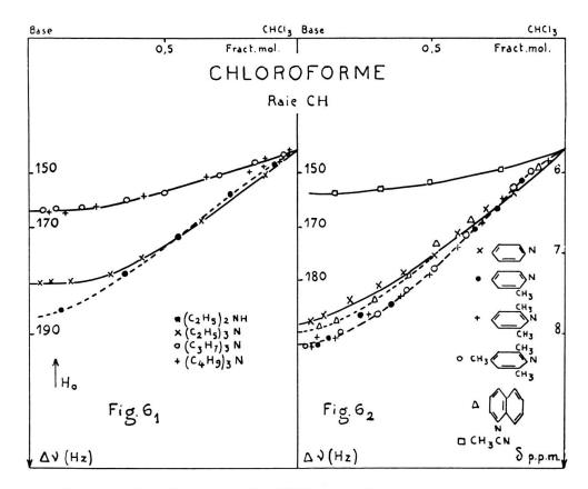
Complexation du proton de CHCl<sub>3</sub> avec divers composés azotés.
