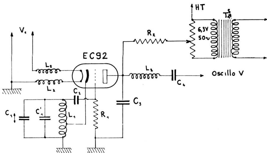
$C_1$ , condensateur vibrant à 50 HZ, 2 à 5 pF.
