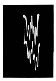
Sur la figure on a montré la structure hyperfine du DPPH en solution  $\frac{1000}{M}$  (signal détecté en amplitude).
