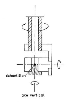
de ce thermocouple ne produit qu'une perturbation négligeable de la cavité; il peut donc être laissé en permanence, à la précision de nos mesures. La cavité comporte des diaphragmes et des ajutages permettant de travailler sous atmosphère contrôlée en légère surpression.
