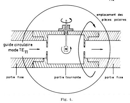
les deux rotations utilisées pour la mesure systématique de Hr sont commandées de l'extérieur et repérées avec précision sur un tambour et un plateau gradués.
