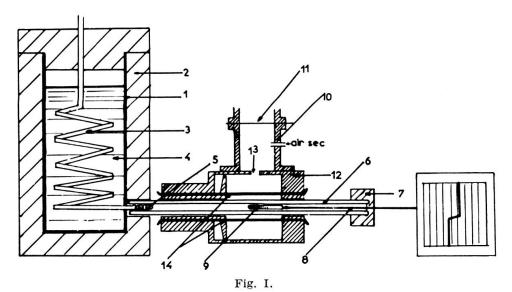
Schéma du système de refroidissement.
