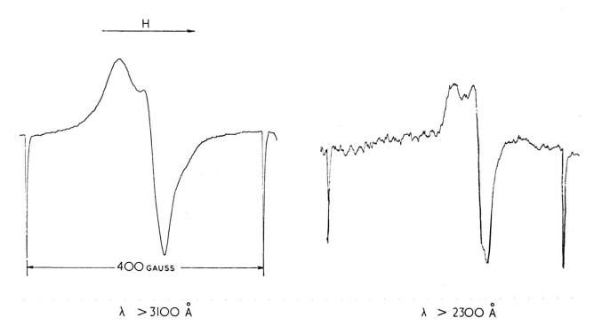
UV IRRADIATION OF  $\rm H_2O_2$  — EFFECT OF DIFFERENT U.V. WAVELENGTHS  $\lambda$  ON SPECTRUIS SHAPE FROM 61-62 %  $\rm H_2O_2$  IRRADIATED AT 90°K Fig. 3.
