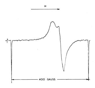
U V IRRADIATION OF  $H_2O_2$  — FIRST DIFFERENTIAL
