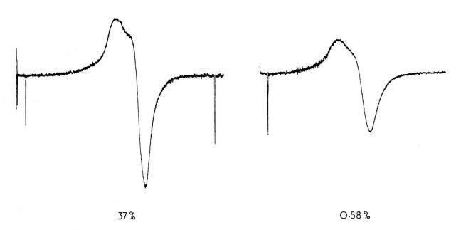
15 MeV DEUTERON IRRADIATION OF  $\rm H_2O_2-VARIATION$  OF SPECTRUM SHAPE WITH RADICAL CONCENTRATION FOR 60%  $\rm H_2O_2$ . IRRADIATION AT 90°K.
