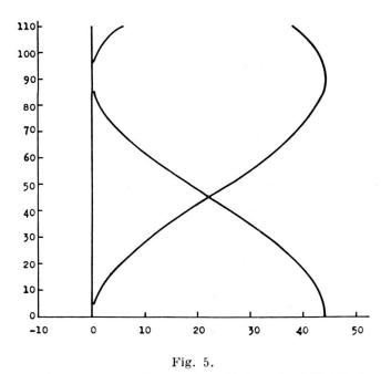
Champs de résonance des centres V dans le LiF-Na irradié en fonction de l'orientation du crystal.
