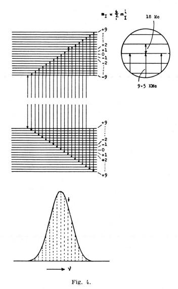
La méthode de la double résonance: les niveaux Zeeman et hyperfins du centre F (cercle: schéma magnifié des niveaux hyperfins adjacents utilisés pour la double résonance; en bas: intensités des componantes de la raie de résonance électronique).
