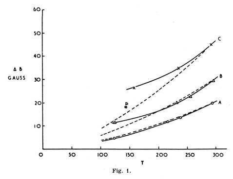
Largeur de la raie de résonance des électrons de conduction dans le silicium en fonction de la température.
