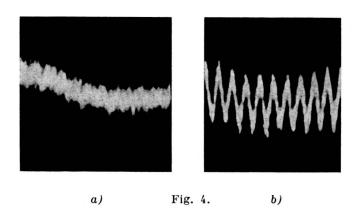
Dans la figure 4b) nous montrons un faible signal hyperfréquence, modulé à 500 cycles, détecté par un bolomètre suivi d'amplificateur. Le signal est détecté avec un amplificateur dont le premier étage est formé de 50 triodes (25 tubes 12AX7) constituant 50 amplificateurs indépendants, dont les sorties alimentent un circuit de somme à résistances.
