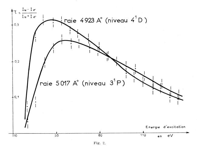
décharge dans la cellule. De plus il faut isoler parfaitement la raie 3  $^{1}\mathrm{P}_{1}$  — 2  $^{1}\mathrm{S}_{0}$  (5017 Å) de la raie 4  $^{1}\mathrm{D}_{2}$  — 2  $^{1}\mathrm{P}_{1}$  (4923 Å) car la résonance du niveau  $^{1}\mathrm{D}_{2}$  apparaît à la même valeur du facteur de Landé et avec une puissance de radiofréquence plus faible (durée de vie plus longue).
