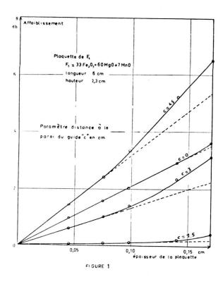
déterminer si (2) est valable. Traçons expérimentalement  $A=f(\alpha)$  pour différentes valeurs de « c » (figure 1); nous voyons que la proportionnalité à  $\alpha$  est respectée pour des valeurs de  $2 \alpha \leqslant 0.9$  cm.
