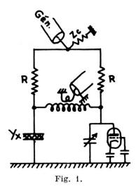
apportées à l'ensemble (fig. 1). Un admittancemètre automatique entièrement électronique a été mis au point. Note de MM. Gabillard et Polaert.
