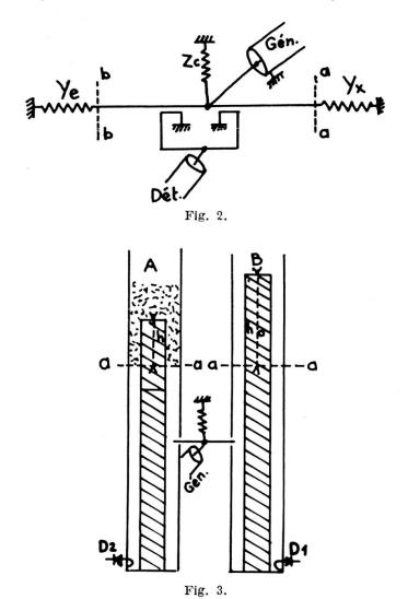
utilisée) à toutes les fréquences. (Les résonances des tronçons latéraux sont pourtant à éviter.) Il permet de s'assurer que deux admittances: l'une étalon, l'autre inconnue sont égales à mieux que  $1^0/_{00}$ . Pour les substances à faibles pertes, l'admittance inconnue est comparée à une susceptance standard, pour les substances à fortes pertes la cellule est comparée à un ensemble thermistance susceptance.
