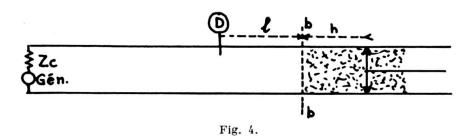
Ces trois types de résonateurs fonctionnent avec une cellule de mesure du type « coaxial » terminée par une *impédance infinie*, de hauteur variable ce qui permet à chaque fréquence d'opérer à susceptance d'entrée constante.
