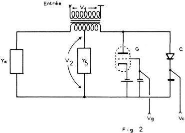
On fait varier G et B en agissant respectivement sur le potentiel de grille de la triode et sur la polarisation inverse de la diode.
