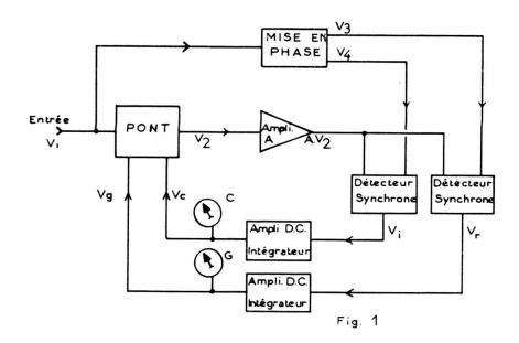
On obtient ainsi deux tensions d'erreur continues proportionnelles, l'une au déséquilibre en conductance  $G_x$ , l'autre au déséquilibre en susceptance  $B_x$  du pont.
