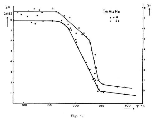
Largeur de la raie et deuxième moment de Th<sub>8</sub> Al<sub>4</sub> H<sub>8</sub> en fonction de la température.
