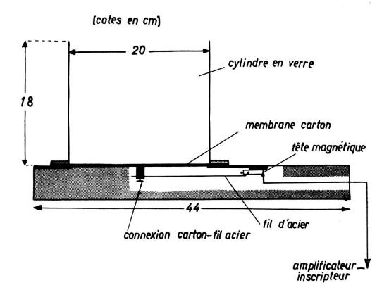
Les vibrations produites par le déplacement des souris sont transmises par voie électromagnétique et enregistrées par l'interposition entre l'aiguille thermo-électrique du scripteur d'une amplification électronique. En l'espèce, nous employons le « Twin Viso » Recorder Sanborn.
