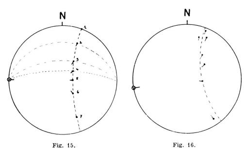
Rotation d'un plan horizontal contenant une structure linéaire •— orientée N 20° E autour d'un axe W-E ⊗—
