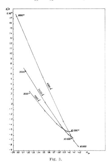
$m_{ab} = f(m_{cd})$  varie de 0,02. Nous voyons qu'il est possible de compenser par un déplacement de la longueur d'onde moyenne d'un des filtres l'effet sur la pente provenant de la différence de largeur de ces derniers. Dans le cas donné comme exemple, le filtre (ab) a une longueur d'onde moyenne de 100 Å supérieure au filtre (cd), il est donc un peu trop du côté du rouge; l'effet
