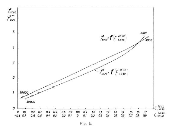
Donc lorsque la distance entre les longueurs d'onde composant l'indice de couleur est inférieure à 750 Å, le gradient peut être déterminé à l'aide de l'expression (20) avec une erreur  $\leq 0.01$  pour autant que les températures envisagées soient comprises entre 3000 et 30.000° et les longueurs d'onde entre 3000 Å et 8000 Å.
